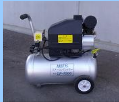
コンプレッサー
